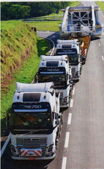
É ASSIM QUE PODEM SER APELIDADOS OS CAMINHÕES VOLVO FH16, NA CONFIGURAÇÃO CAVALO MECÂNICO 8X4, QUE ESTIVERAM À FRENTE DO TRANSPORTE DE UM ROTOR SUPERDIMENSIONADO.
